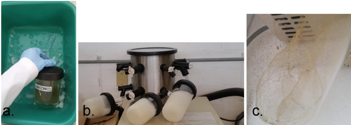
Figura 4. Proceso de liofilización: a) Baño frío de acetona y hielo seco, b) frascos con la infusión congelada en proceso sublimación, c) extracto liofilizado obtenido.
