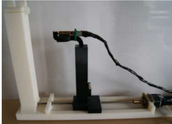
Figura 33. Dispositivo para montaje de la muestra y medición del módulo de Young.
