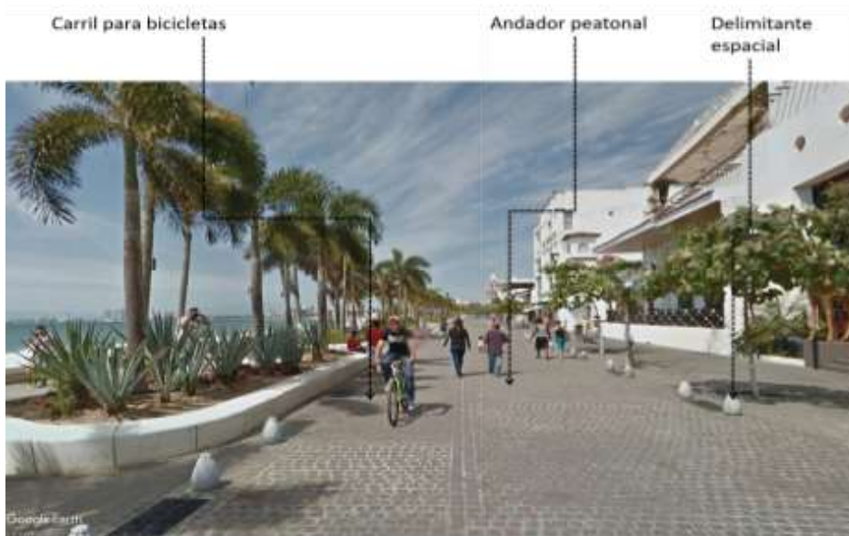
Ilustración 50 Análisis espacial del nuevo malecón, la delimitación espacial entre el área peatonal y el área designada para el uso de la bicicleta ha resultado poco apropiada, la vegetación existente no produce sombra , las jardineras son usadas como área de descanso. Fuente; imagen googleearth 2017, edición propia.
