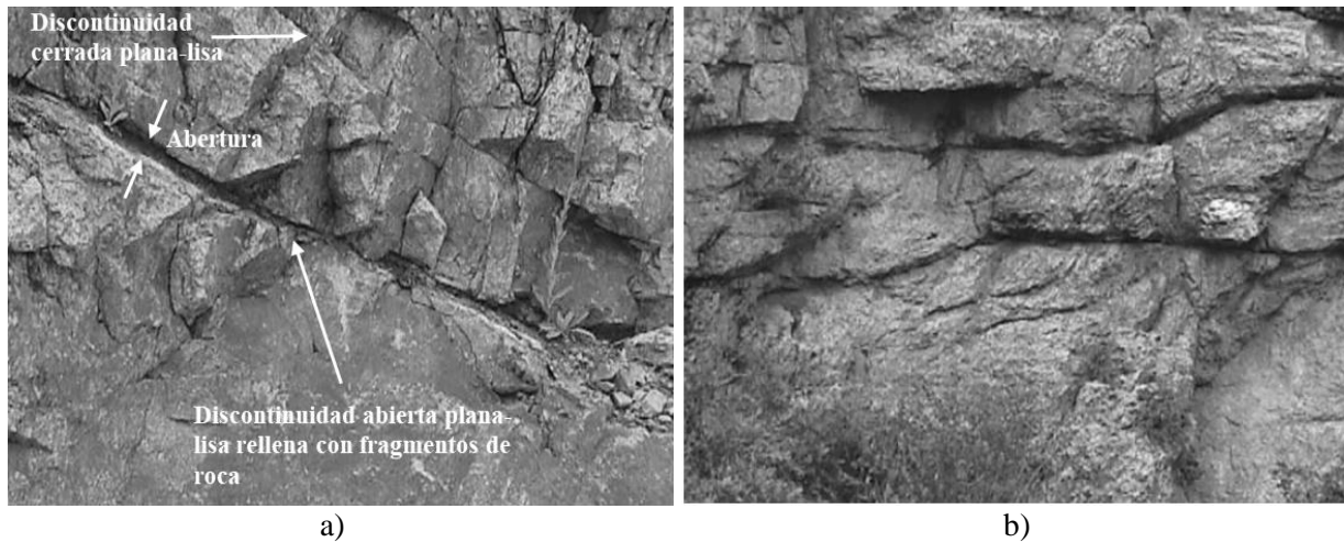
Figura 7.39. (a) Discontinuidades planas y (b) onduladas (Annandale, 2006).
