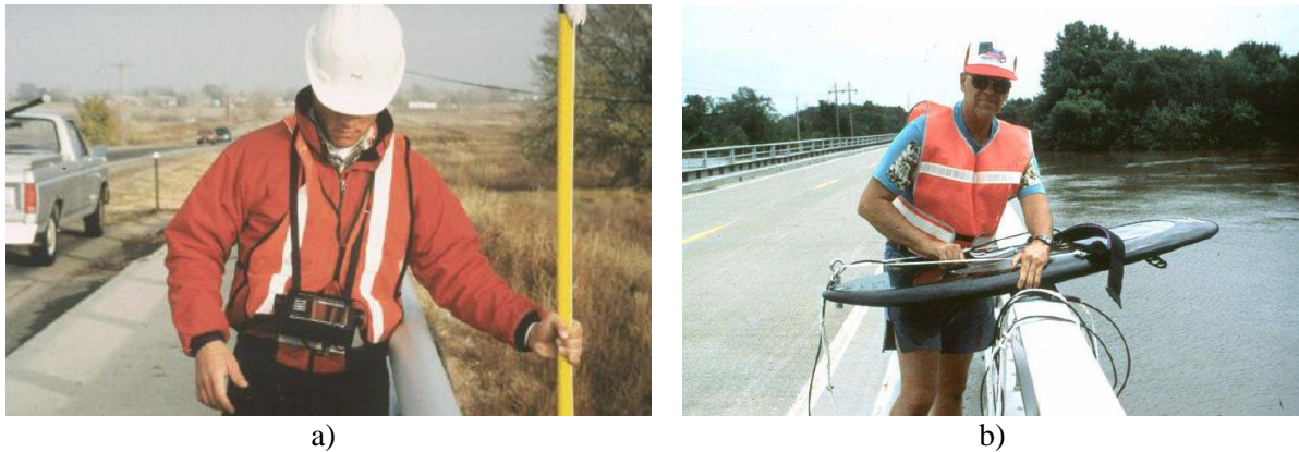
Figura 7.48. Ecosondas o fatómetros portables instalados en: (a) una barra y; (b) tabla de surf. (Richardson, 2002).
