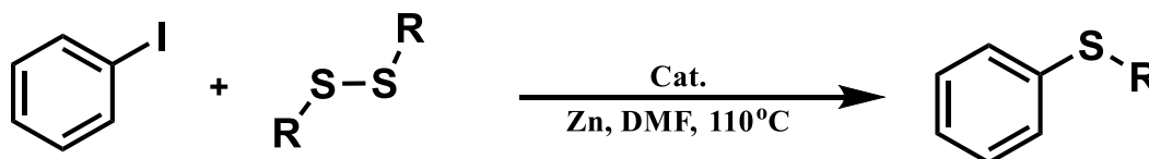
Figura 35. Esquema de reacción para el acoplamiento catalítico del enlace C-S
