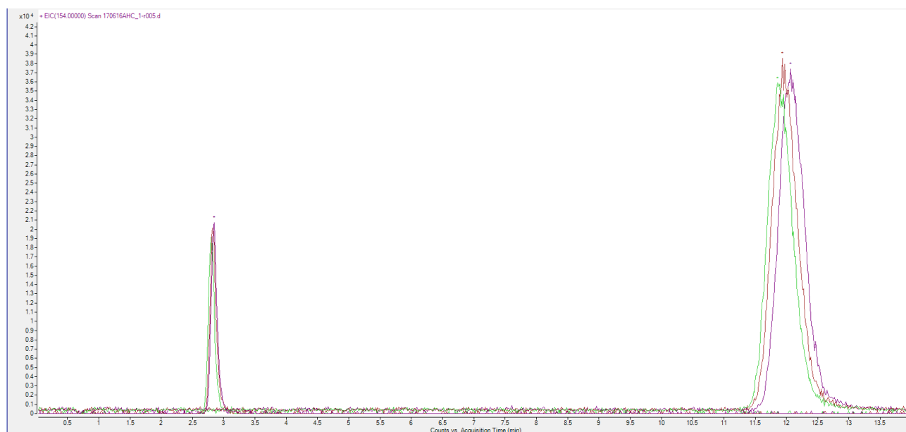
Figura 19. Cromatograma del compuesto USIP-TR-01 ( Tr = 12 ) y Estándar interno ( Tr = 2.9 ) en fase móvil con una proporción 13/87 ACN/HFBA 20mM, 50ng/mL para ambos compuestos.
