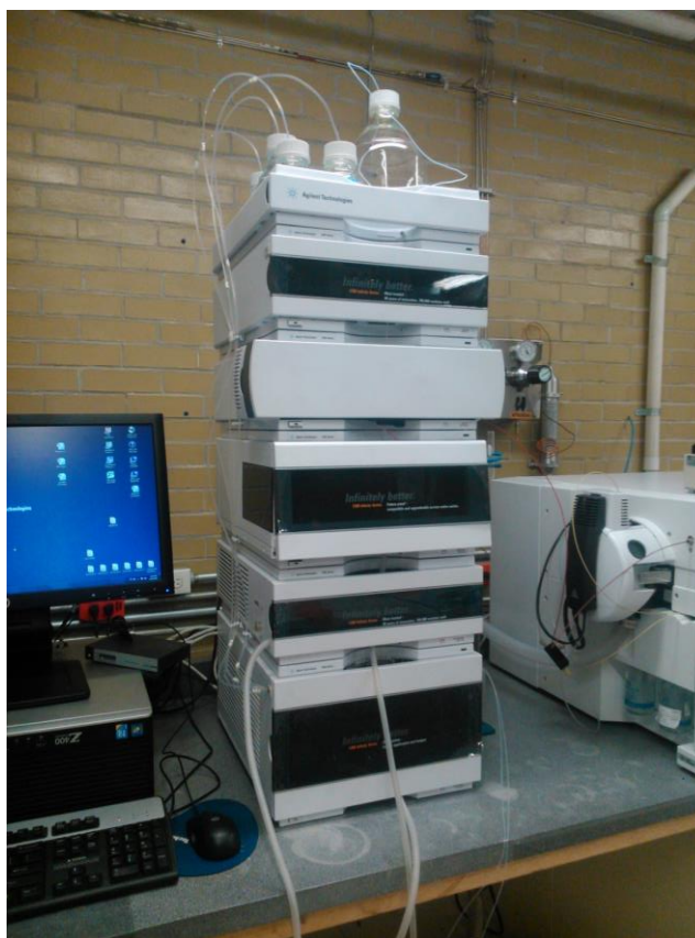
Figura 2. Cromatografo de líquidos modelo 1290 infinity marca Agilent Technologies.
