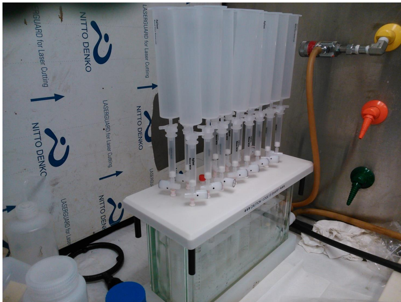
Figura 5. Equipo de extracción en fase sólida.
