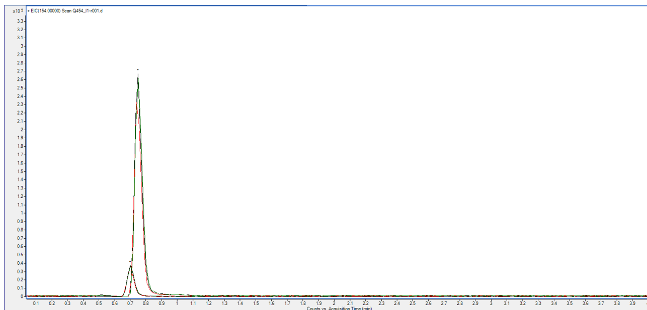
Figura 15. Cromatograma del compuesto USIP-TR-01 ( Tr = 0.75 ) y Estándar interno ( Tr = 0.7 ) en fase móvil con una proporción 50/50 ACN/HFBA 20mM, 50ng/mL para ambos compuestos.
