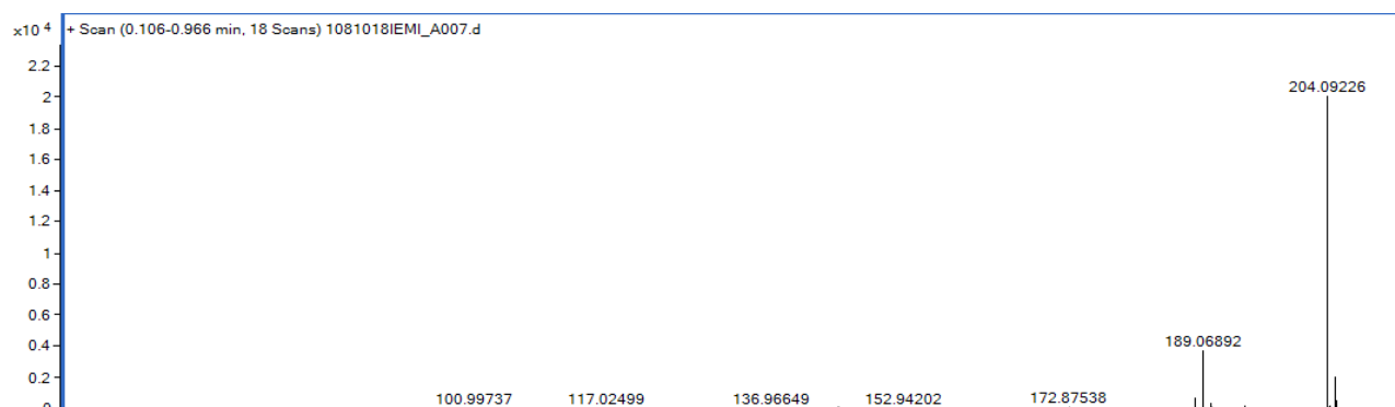
Figura 10. Fragmentación del Ion 204.09 m/z con una energía de colisión de 10
