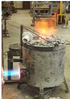
Figura 4.15 Descerado y sinterizado de la cáscara rotor 5 álabes.
