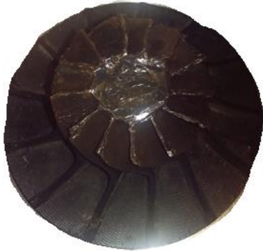
Figura 4.9 Patrón de cera final del rotor de 13 álabes.
