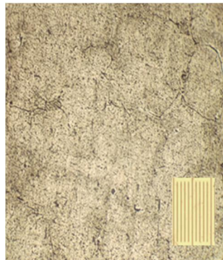
Figura 5.11 Microestructura 100X de 6061 como colada.
