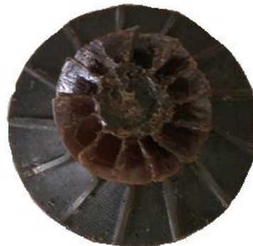
Figura 4.8 Patrón de cera de 13 álabes con retoques.
