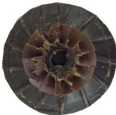
Figura 4.7 Patrón en cera de 13 álabes con defectos.
