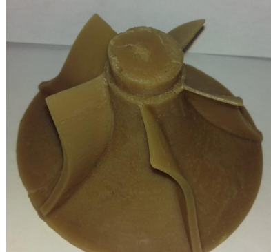
Figura 4.10 Patrón en cera de rotor 5 álabes.
