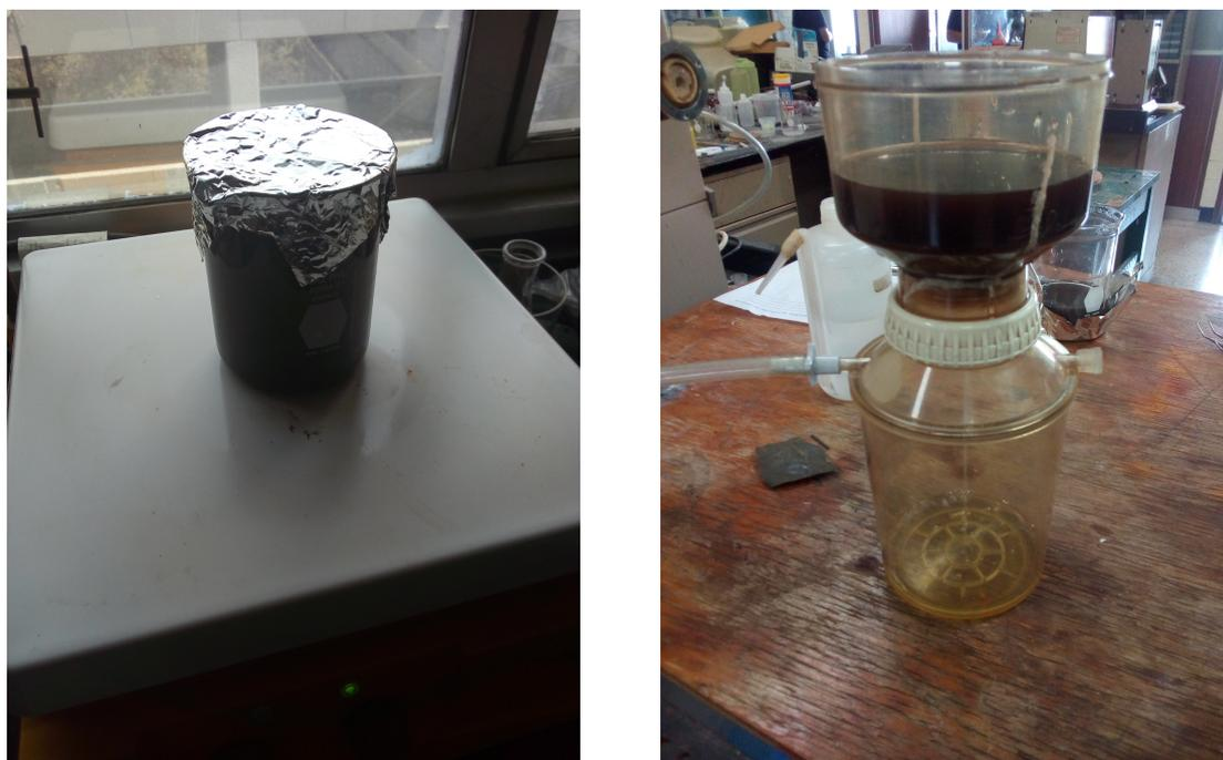
Figura 1.6: Imagen izquierda lavado de la sal en la muestra con agua destilada a 60°C y a la derecha el proceso de filtrado.
