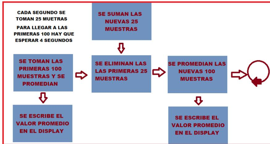
Figura 3.16 Diagrama a bloques del programa.
