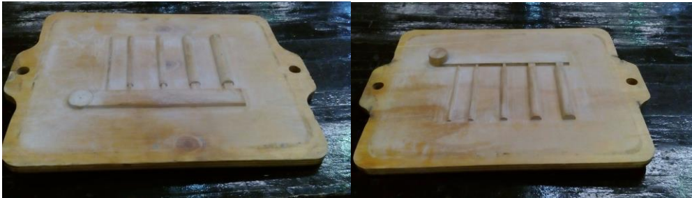
Figura 11. Placa modelo empleada en cada prueba. Imagen de la izquierda corresponde al cope y la de la derecha al drag.
