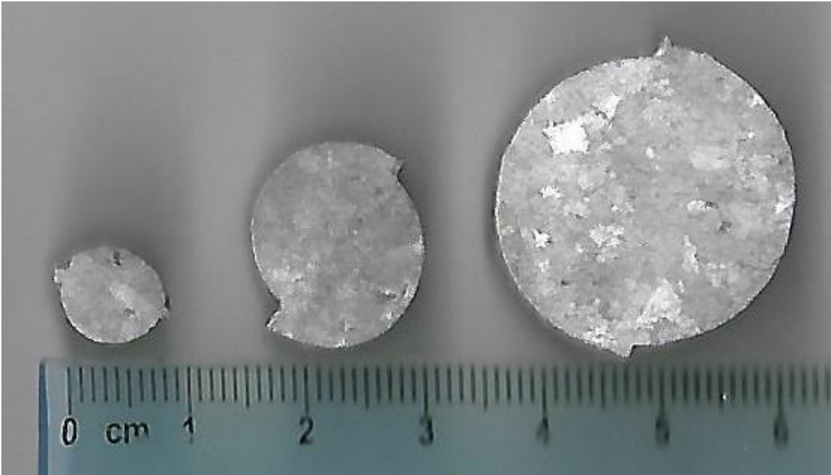
Figura 66. Estructuras para condición 0.02%Sr con 5 minutos de tratamiento.
