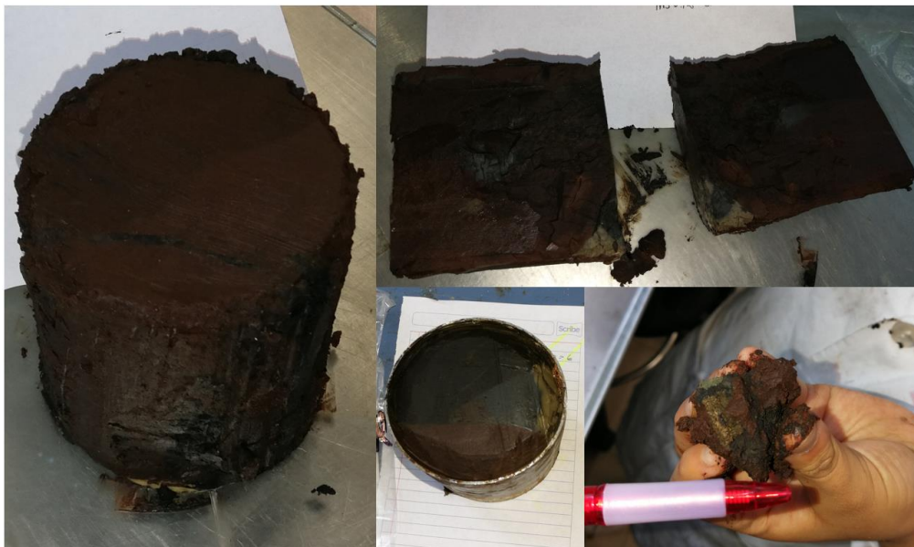
Figura 6.3 Muestra A, suelo de 0 a 20 cm de TOP a BOTTOM de tubo.
