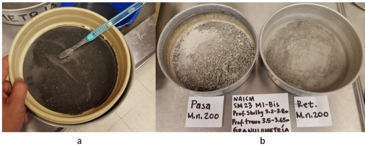
Figura 6.15 Desarrollo de la prueba de granulometría para el primer subconjunto de B. a) Lavado de la muestra. b) Suelo que pasó la malla No. 200 y suelo que no pasó la malla No.200.
