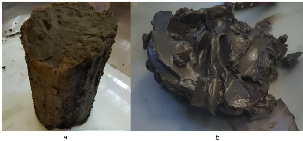
Figura 6.7 Segundo subconjunto. a) Muestra extraída. b) suelo remoldeado.
