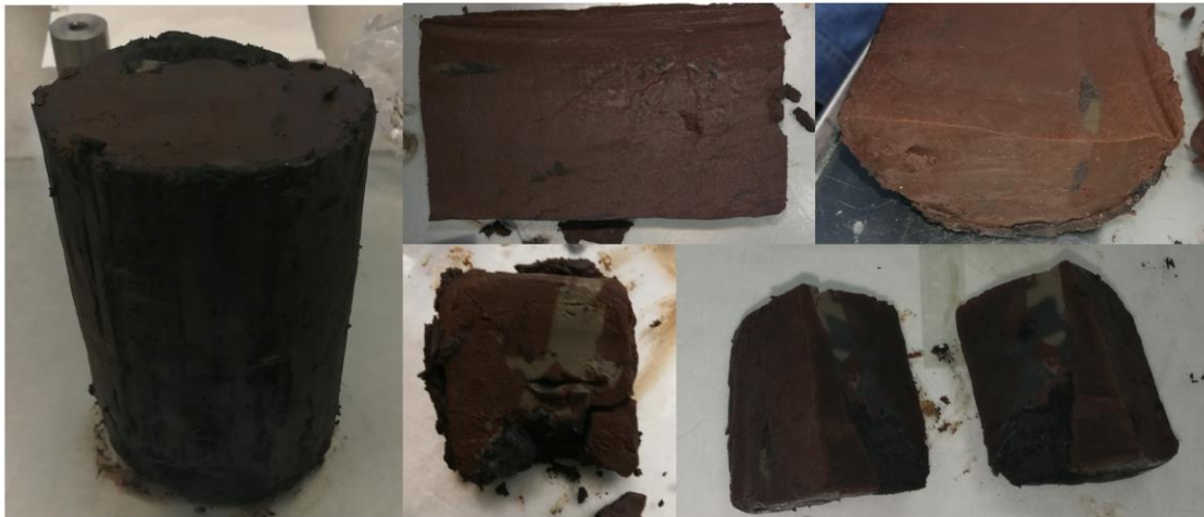
Figura 6.4 Muestra A, suelo a la mitad de tubo.
