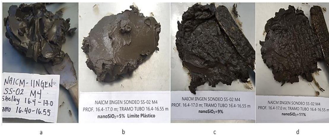
Figura 6.16 Segundo subconjunto de B. a) Suelo en estado natural. b) Muestra con 5% de nanoSiO 2 . c) Muestra con 9 % de nanoSiO 2 . d) Muestra con 11 % de nanoSiO 2 .
