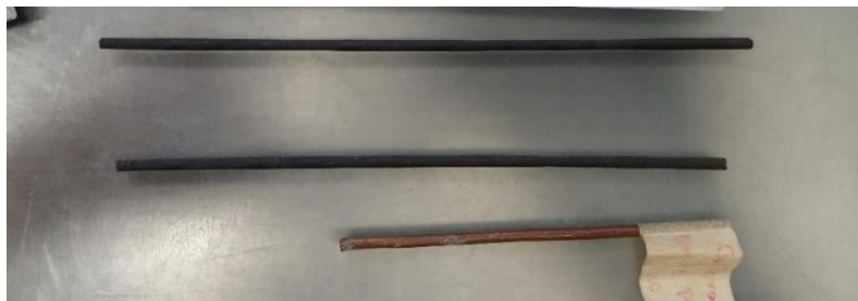
Figura 4.5 Rollitos de 3 mm, para determinar el límite plástico del suelo.
