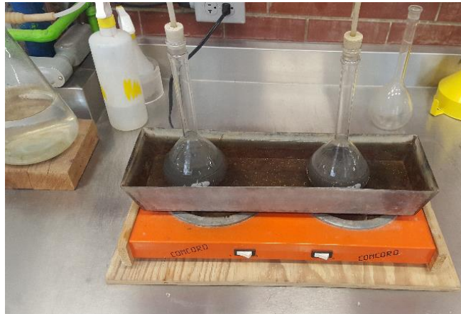
Figura 6.13 Desarrollo de la prueba de densidad de sólidos.
