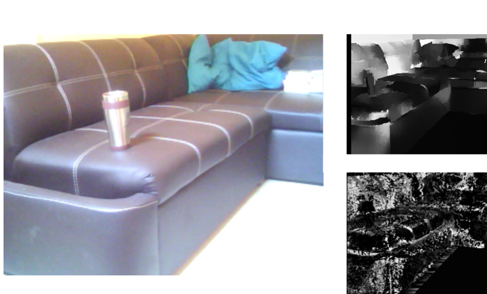
Figura 5.6: Disparidad obtenida Izquierda: Imagen original izquierda. Derecha inferior: Disparidad obtenida sin aplicar el filtro wls. Derecha superior: Disparidad obtenida al aplicar el filtro wls.
