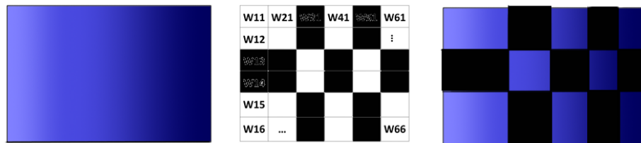
Figura 3.4: Ejemplo de operación directa con una máscara sobre una imagen de un degradado
