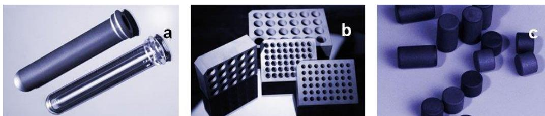
**Figura 10.** Accesorios de reactor de microondas fabricados con carburo de silicio: (a) recipiente de reacción de 10 ml junto a un vial de borosilicato estándar con las mismas dimensiones para instrumentación monomodo, (b) placas de microtitulación con diferentes matrices y (c) cilindros de SiC para un microondas multimodo.
