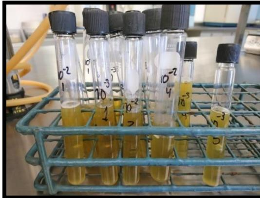
*Figura 14.* Prueba confirmativa caldo lauril sulfato sodio de coliformes totales
