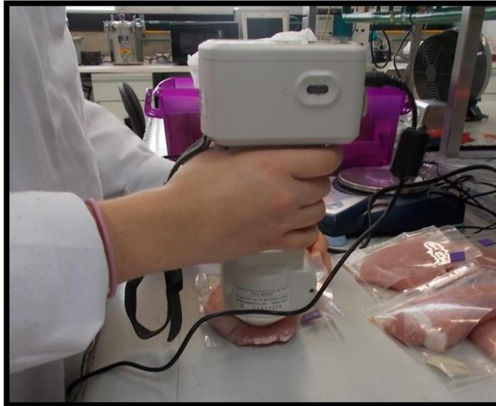
Figura 9. Medición de color empleando el colorímetro
