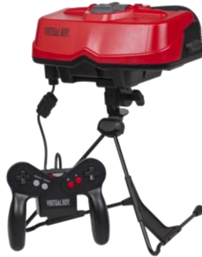
FIGURA 15 Virtual Boy (Casco de realidad virtual más control) de Nintendo IMAGEN: (Wikipedia, 2018)
