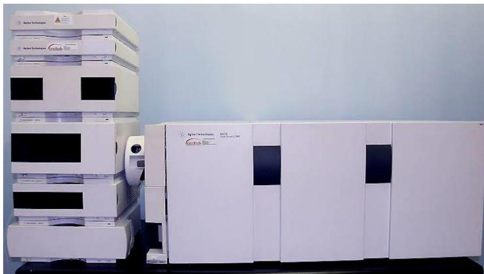
**Figura 20. HPLC-MS con analizador de masa triple cuadrupolo, Modelo Agilent 6410.**
