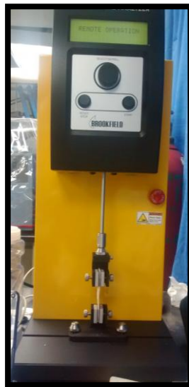
Figura 19. Texturometro Brookfield CT3, prueba de tensión
