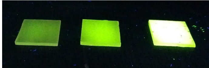
Figura 4.35. Fotografía tomada a las películas de \text{SrAl}_2\text{O}_4: \text{Tb}^{3+} con las concentraciones de 4, 6 y 8 at.%, respectivamente. Excitadas por luz ultravioleta con una longitud de onda en 250 nm.
