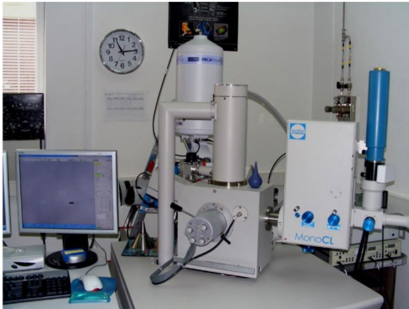
Figura 1.5. Equipo de cátodoluminiscencia acoplado a un microscopio electrónico de barrido.
