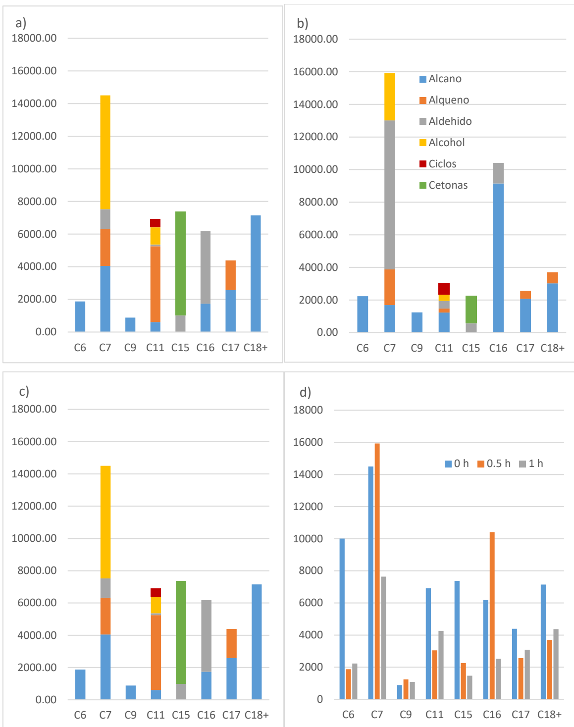
Gráfica 6-14. Áreas cromatográficas por grupos funcionales para las reacciones Ni(5%)/H-BEA R20D40 en función del tiempo. a) 0 horas, b) 0.5 horas, c) 1 hora y d) Comparación de 0 horas, 0.5 horas y 1 hora.
