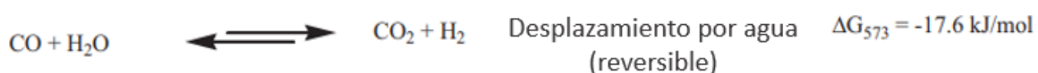
Figura 2-5. Esquema de reacción de cambio agua-gas con datos termodinámicos ( \Delta G_{573} en kJ/mol a 1 bar) (Gosselink, Hollack, & Chang, 2013).
