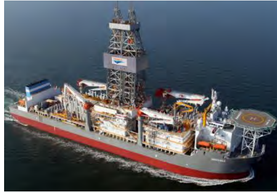
Figura 6. Buque de perforación. (tomada de ENSCO, 2017)
