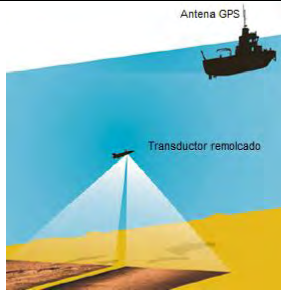
Figura 14. Sonar de barrido lateral. (modificada de Finkl & Makowski, 2016)
