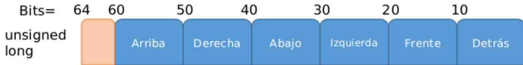
Figura 3.6: Codificación de valores de afinidad para un vóxel con respecto a sus 6 vecinos. Se puede apreciar que en un dato del tipo unsigned long , se pueden almacenar los 6 niveles de afinidad, ocupando cada uno de ellos 10 bits, desperdiciando los 4 bits restantes.
