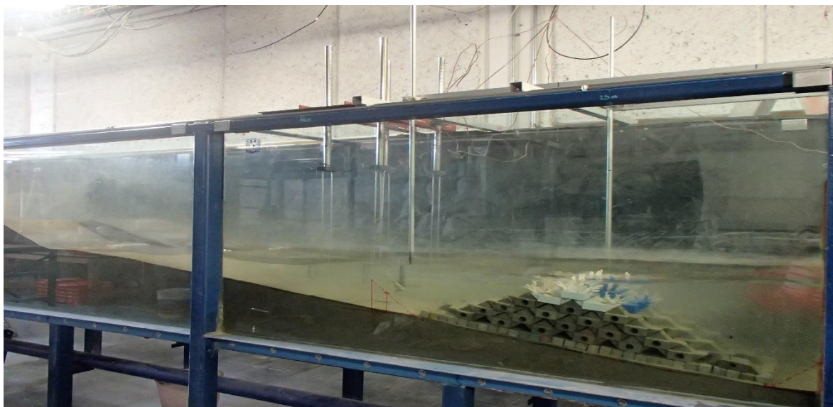
Figura 71. Posición de los diques en la parte baja del perfil de arena.
