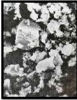
Imagen 73 Material de relleno “en partículas gruesas” utilizado en resinas compuestas convencionales.
