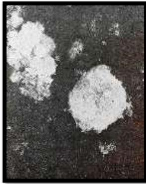
Imagen 74. Aglomerados de filtro de sílice coloidal, presentes en resinas compuestas con microrrelleno.
