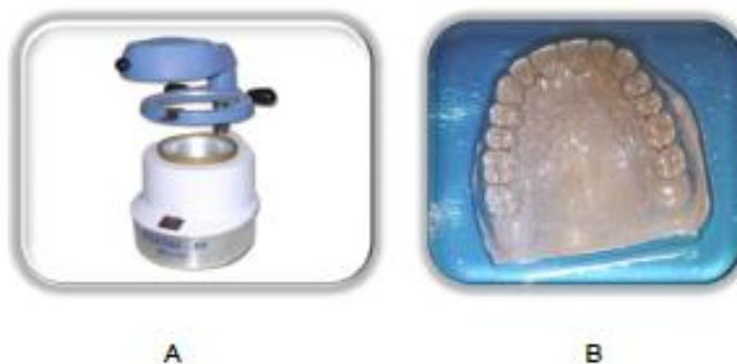
Figura 90. A) plastificador al vacío. B) matriz plastificada sin recortar.
