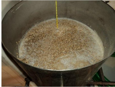
Figura 12: proceso de Maceración de malta de cebada
