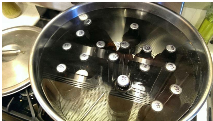
Figura 17: Pasteurización de cerveza artesanal
