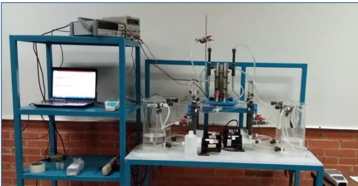
Figura 3.23. Sistema físico utilizado para la experimentación de electrodeionización.
