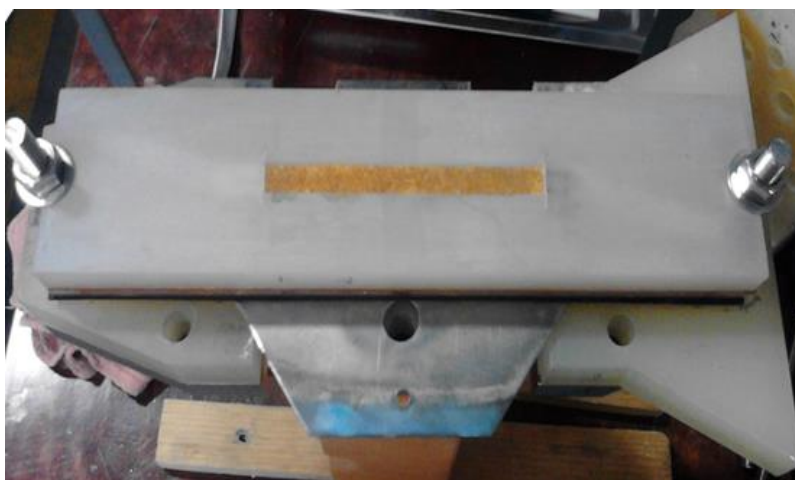
Figura 1.8. Vista de un módulo IXED donde se aprecia la resina aniónica [13].
