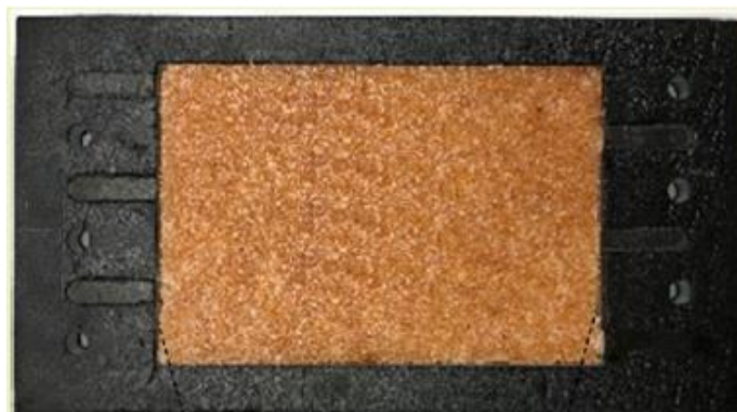
Figura 1.6. Vista de un módulo (RW-EDI) donde se aprecia la resina de intercambio iónico porosa [12].
