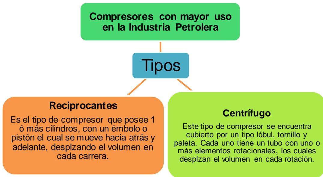
Fig. 2. 25 Esquema de compresores con mayor relevancia en la Industria
