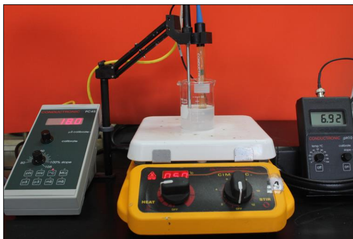
Figura 9.- Sistema para determinar la cinética de reacción de los materiales cerámicos.
