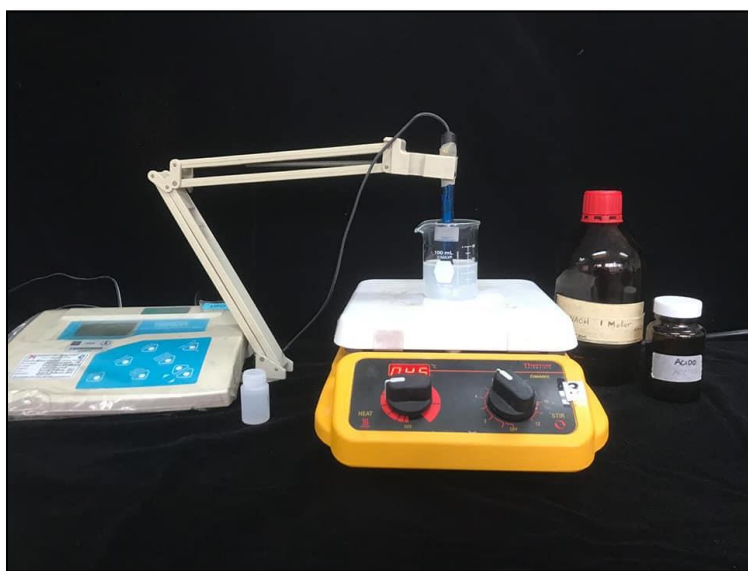
Figura 6.-Calibración de pH con ácido acético y NaOH.
