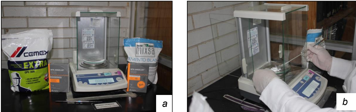
Figura 7.-Determinación de masa de los materiales cerámicos (a) en la balanza analítica (b).
