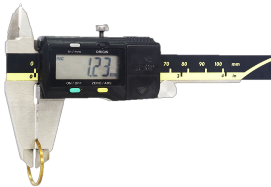
Figura 3.- Anillo de bronce de 1.23mm de altura medido con Vernier digital.
