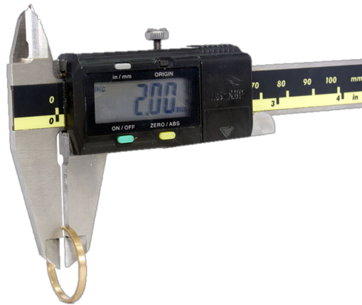
Figura 10.- Anillo de bronce de 2mm de altura medido con vernier digital.
