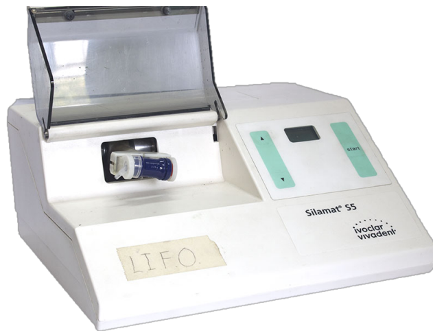
Figura 13.- Máquina amalgamadora con cápsula de Riva self cure® colocada.
