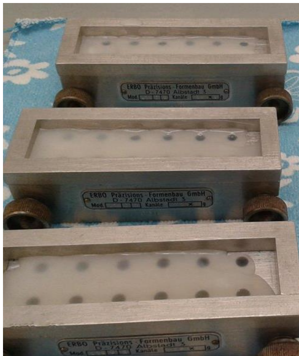
Figura 14. Preparación de los óvulos por fusión. Vaciado en moldes.
