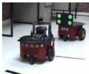
Ilustración 20 Robot con transmisión diferencial [I20].
