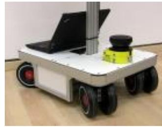
Ilustración 27 Base con movimiento omnidireccional [126].
