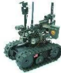
Ilustración 18 Robot con sistema de desplazamiento mediante orugas [I18].
