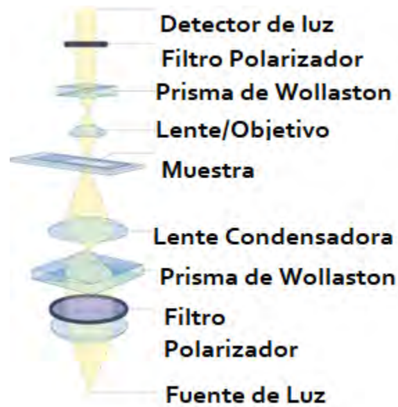
Fig. 1.5. Los componentes básicos de un arreglo experimental para microscopía de contraste de interferencia diferencial [24].
