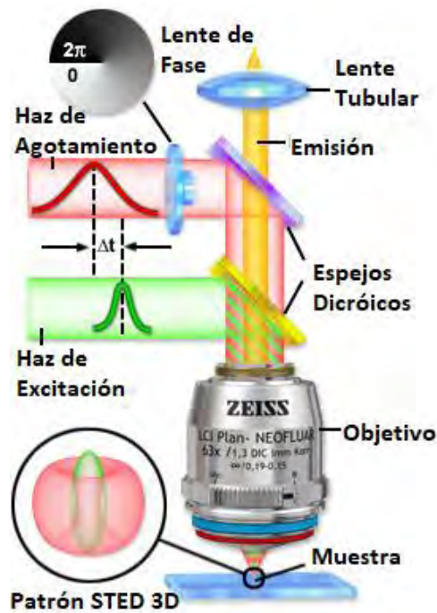
Fig. 3.3. Arreglo experimental habitual de Microscopía STED [5].
