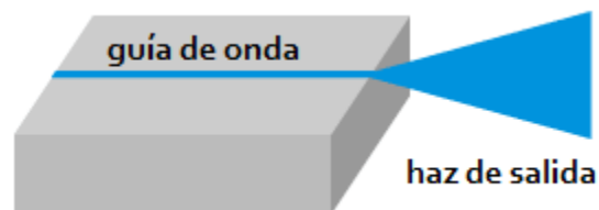
Fig. 2.8. Esquemático de un diodo láser de baja potencia de borde emisor. No se muestran las estructuras electrónicas.
