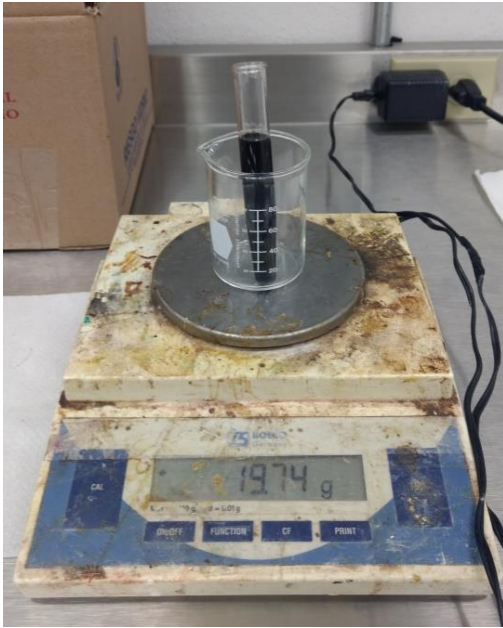
Fig. 32 y 33 Izq. Tubos de vidrio con mezcla de nanopartículas pesando 19.74g. Der. Centrífuga a 3000 RPM y 10 min.
