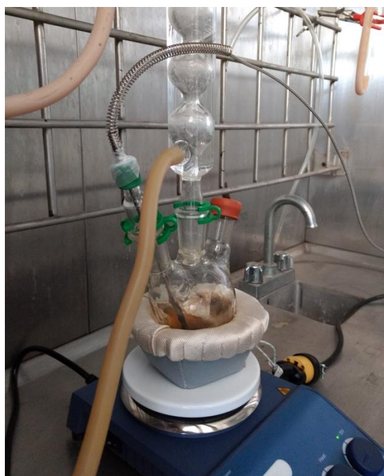
Fig. 27 De izq. a derecha, boca 1: adaptador con termopar, boca central: condensador de rosario, boca 3: septa para inyección de OLA+S.
