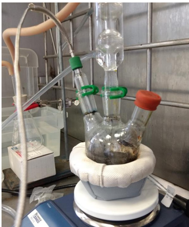
Fig. 30 Mezcla de precursores a 270°C después de la inyección de OLA+S.
