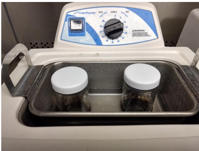
Fig. 37 Preparación de la tinta solar en el equipo de ultrasonido.
