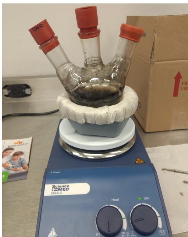
Fig. 31 Nanopartículas en agitación con etanol : tolueno en relación 5 : 1.
