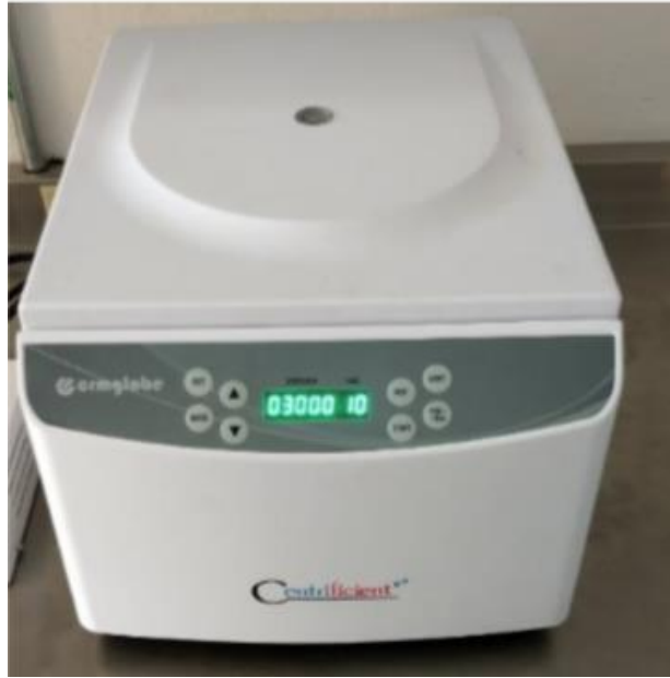
Fig. 32 y 33 Izq. Tubos de vidrio con mezcla de nanopartículas pesando 19.74g. Der. Centrífuga a 3000 RPM y 10 min.
