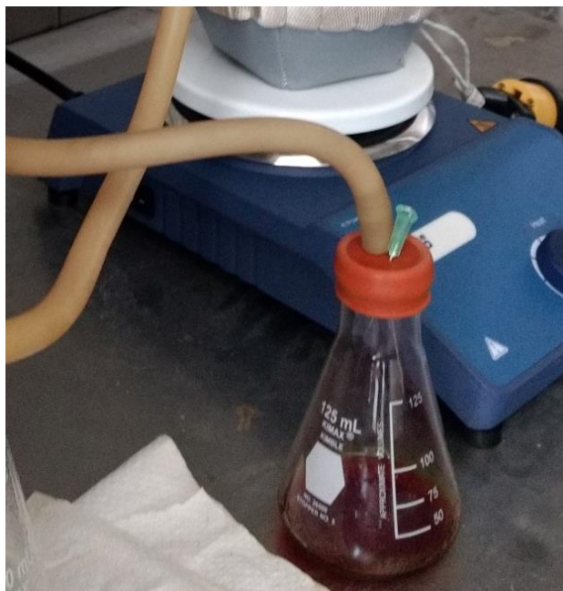
Fig. 29 Mezcla de OLA con S en flujo de nitrógeno.
