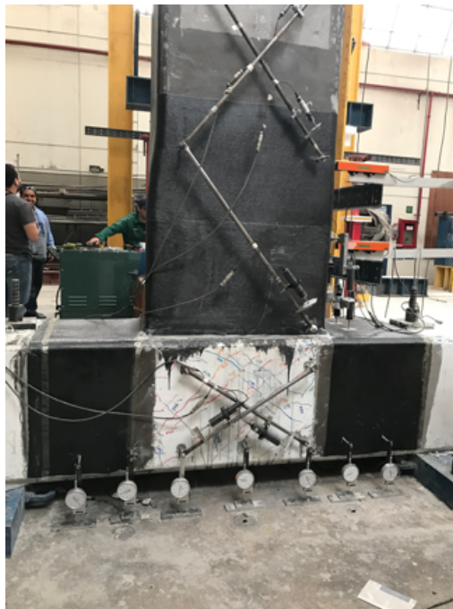
Figura 4.15. Instrumentación de la conexión viga-columna reforzada con PRFC
