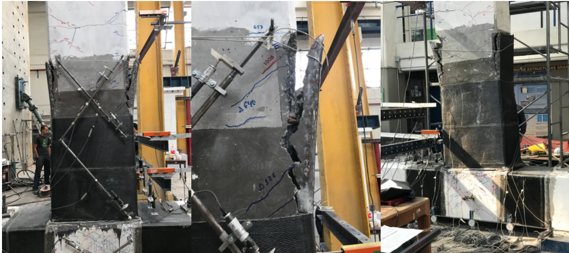
Figura 4.16. Final de la prueba, conexión viga-columna reforzada con el sistema PRFC, CENAPRED
