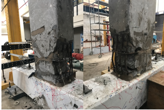
a) Conexión viga-columna dañada, primera prueba, CENAPRED
