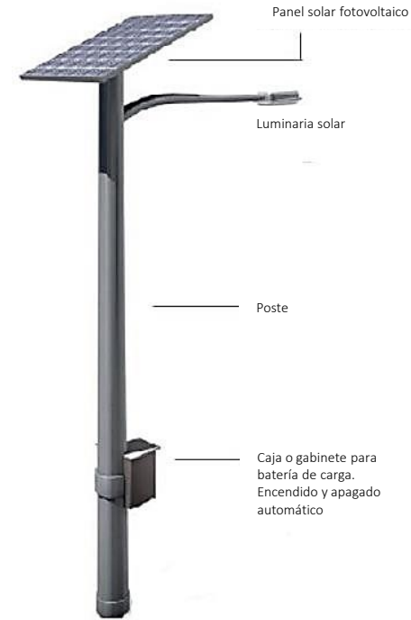
Imagen 59 Propuesta de lámparas de alumbrado público con celdas solares en la localidad.
