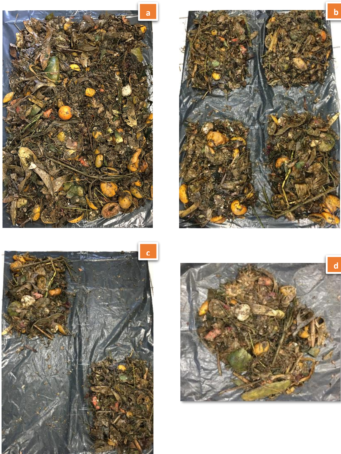
Figura 7.2. Cuarteo en laboratorio: a) 20 kilos de residuos, b) división de FORSU en 4 partes, c) eliminación de 2 partes opuestas, se repite procedimiento y d) muestra representativa de FORSU para su caracterización.
