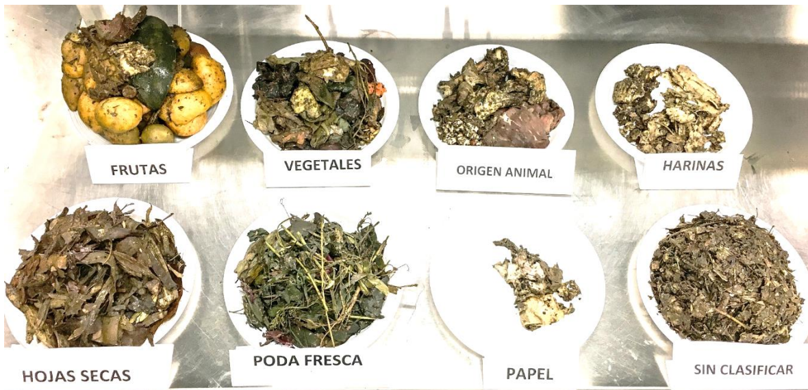
Figura 7.3. Fracciones identificadas al inicio de la separación de la FORSU
