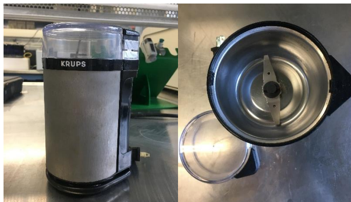
Figura 6.7. Molino para sustratos con humedad menor al 60%
