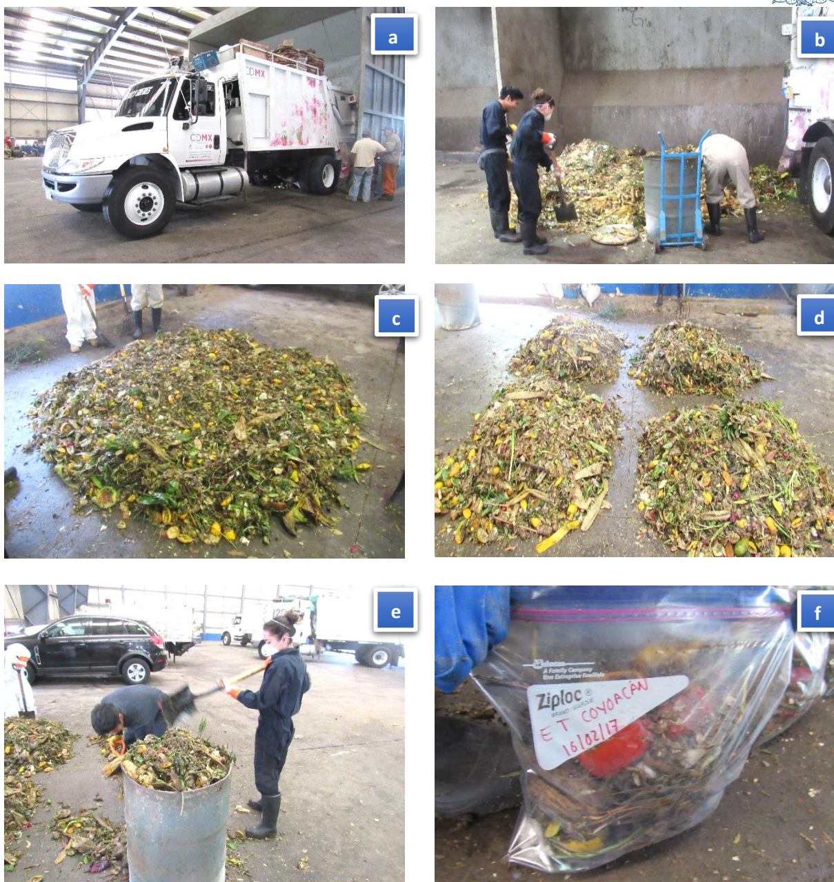
Figura 7.1. Etapas del proceso de muestreo: a) camiones de recolección de residuos y b) descarga de residuos para la obtención de la muestra, c) mezcla obtenida de los residuos de 11 camiones, d) cuarteo en sitio, e) Pesaje de residuos, f) almacenamiento de FORSU en bolsas Ziploc para su posterior congelación.
