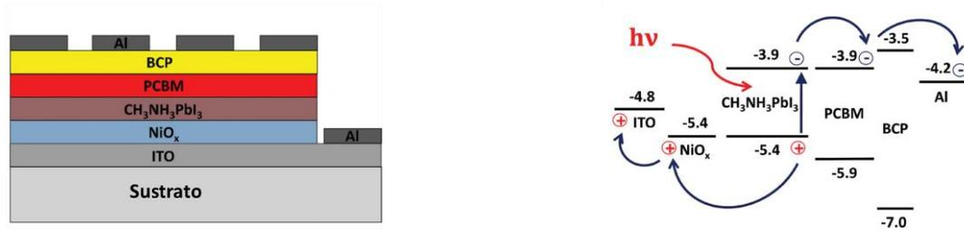
Figura 1.4. a) Configuración de la arquitectura invertida, vidrio/ITO/NiO<sub>x</sub>/CH<sub>3</sub>NH<sub>3</sub>PbI<sub>3</sub> perovskite/PCBM/BCP/Al, de una PSC con NiO<sub>x</sub> como HTM b) diagrama de los niveles de energía de cada capa (tomado de Jeng et al., 2014).
