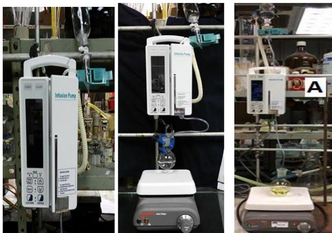
**Figura 9.1** Montaje del equipo para reacciones con Alta Dilución, donde A = bomba de infusión.
