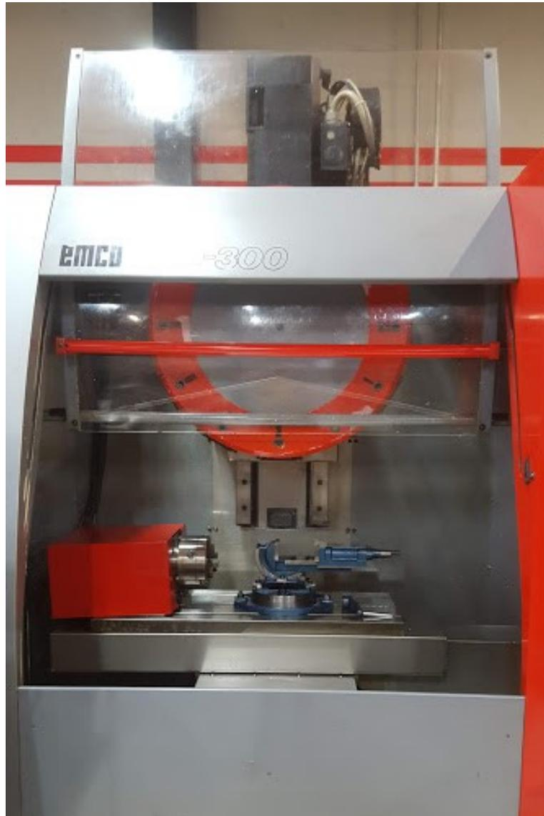
*Figura 2.4.- Centro de Maquinado Vertical VMC 300*
