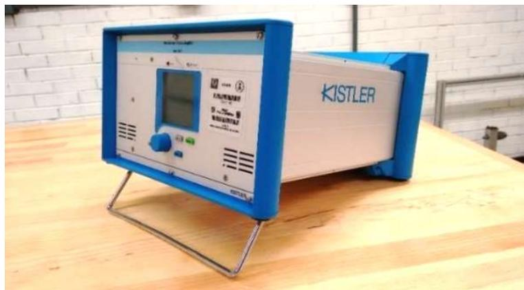
**Figura 3.3.-Amplificador de carga.**
