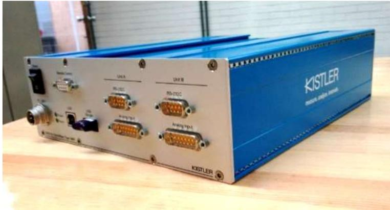
*Figura 3.4.-Tarjeta de adquisición de datos.*
