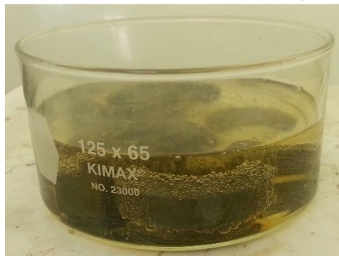
Fig. 3.15 Piezas de acero dentro de solución de HNO 3 al 50% a 80°C.
