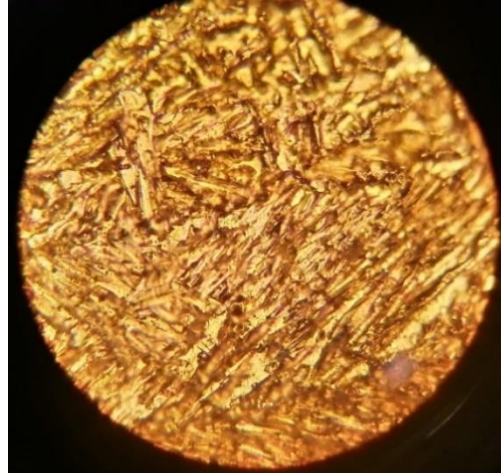
Fig. 4.51 Pieza de latón microatacada vista a 400X.
