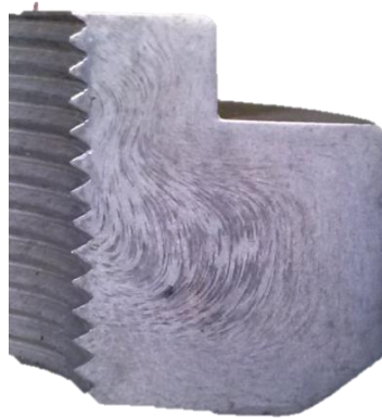
Fig. 4.1 - Pieza de acero macroatacada.
