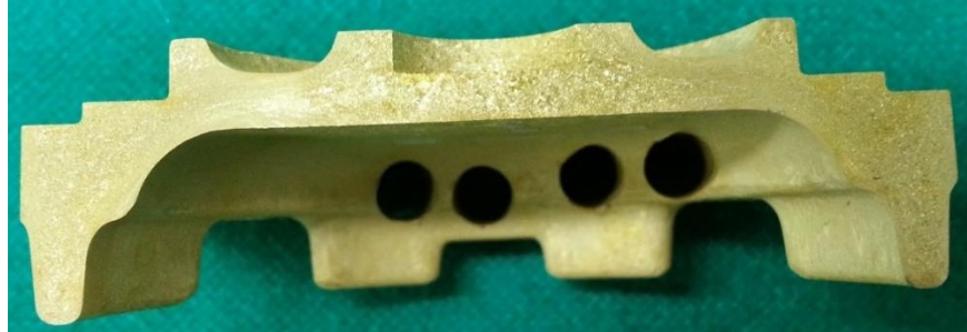
Fig. 4.16 Parte de una probeta Cabeza senior macroatacada.
