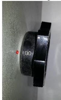
Fig. 3.23 - Perilla de selección de carga de durómetro Rockwell.
