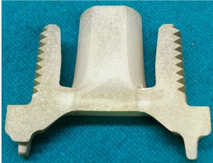
Fig. 4.7 – 2do corte de la pieza Hexagonal 1 ¼” NPT macroatacada.
