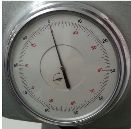
Fig. 3.27 Carátula del durómetro antes de aplicar la carga principal.
