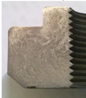
Fig. 4.2 - Pieza macroatacada con dificultad para observar líneas de flujo.
