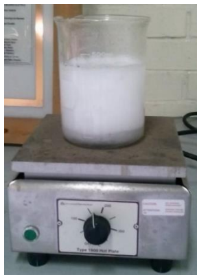
Fig. 3.14 Pieza de acero dentro de la solución de HCL al 50% a 80°C.
