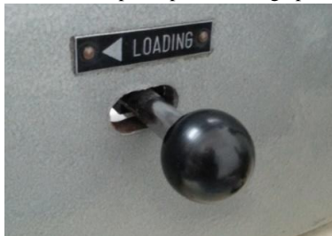
Fig. 3.28 Palanca para aplicar la carga principal.
