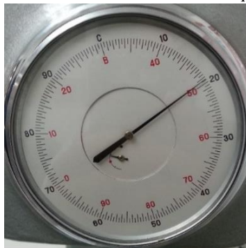
Fig. 3.29 La carátula muestra la deformación total que sufre la pieza.
