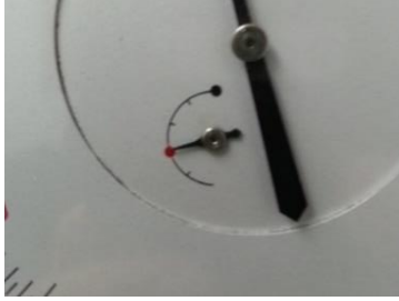
Fig. 3.26 Aguja de precarga con precarga aplicada.
