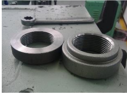
Fig. 3.12 Cople refrentado y cople sin refrentar.
