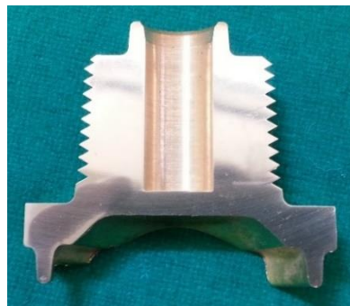
Fig. 4.8 Hexagonal 1” cortada y pulida con acabado espejo.
