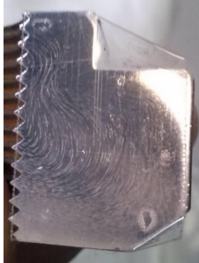
Fig. 4.3 - Pieza de acero macroatacada y posteriormente pulida.
