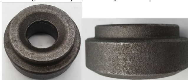
Figura 3.1 – Cople de acero forjado sin maquinar.
