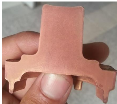
Fig. 4.4 - Perfil de pieza de latón macroatacada, con dificultad para ver líneas de flujo.
