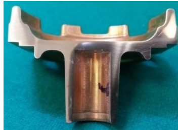
Fig. 4.14 Cabeza senior cortada y pulida hasta acabado espejo.
