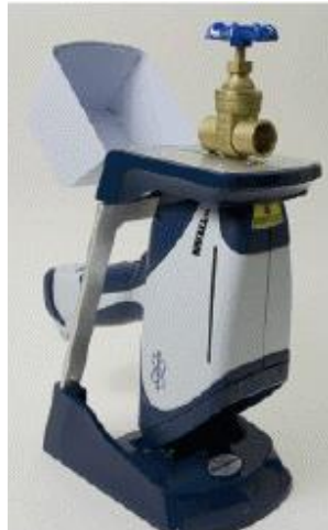
Fig. 3.22 Ejemplo del análisis químico a una válvula de latón.
