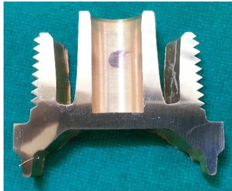
Fig. 4.5 - Pieza de latón Hexagonal 1 ¼" NPT cortada y con acabado espejo.
