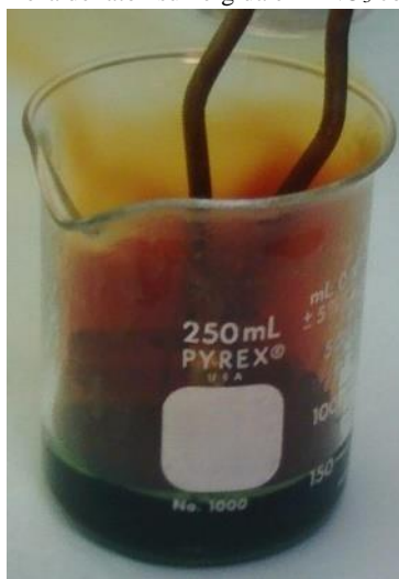
Fig. 3.19 Pieza de latón sumergida en \text{HNO}_3 concentrado.
