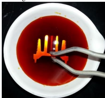
Fig. 3.16 Pieza de latón sumergida en solución de ácido crómico y sulfato de sodio.
