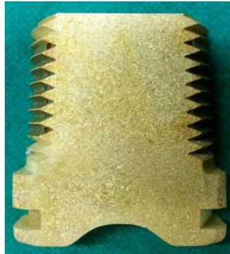
Fig. 4.13 Vista trasera de Snap on 1" macroatacada.
