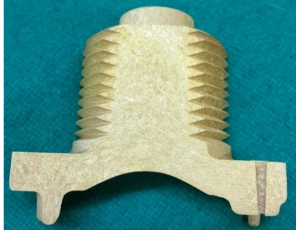
Fig. 4.10 Otra vista de Hexagonal 1" NPT macroatacada.
