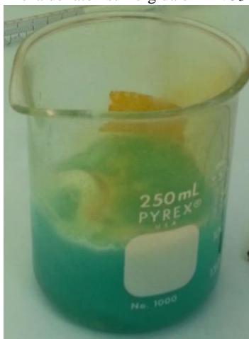
Fig. 3.18 Pieza de latón sumergida en \text{HNO}_3 y \text{AgNO}_3 .
