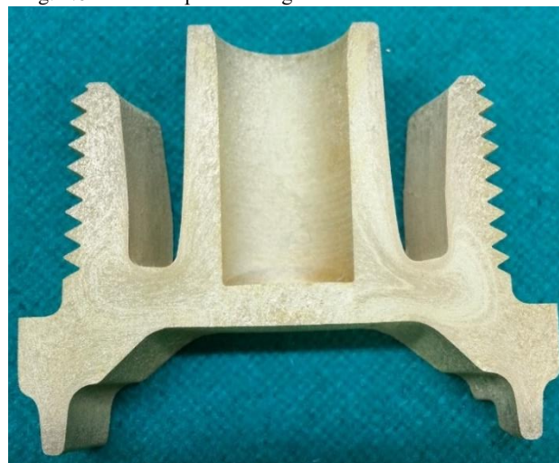
Fig. 4.6 - Corte de pieza Hexagonal 1 ¼" NPT macroatacada.
