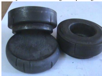
Fig. 2.12 Piezas forjadas de acero con grietas por fragilidad en caliente.
