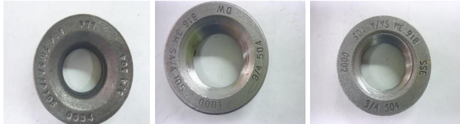
Fig. 3.2 - Coples de acero. De izquierda a derecha PTT, DW y SSE.
