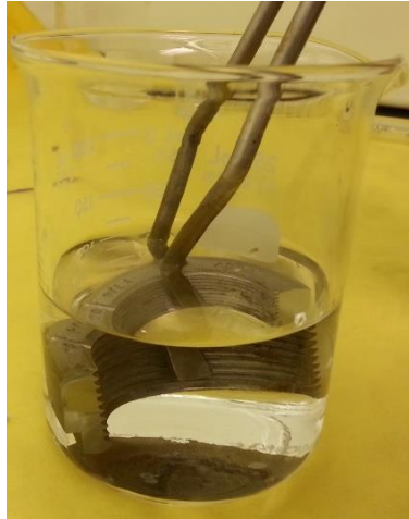
Fig. 3.20 Microataque con solución de alcohol etílico y HNO 3 al 5% a pieza de acero.
