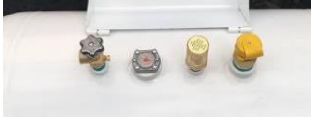
Figura 1.9 - Indicador de nivel instalado en tanque estacionario con brida.
