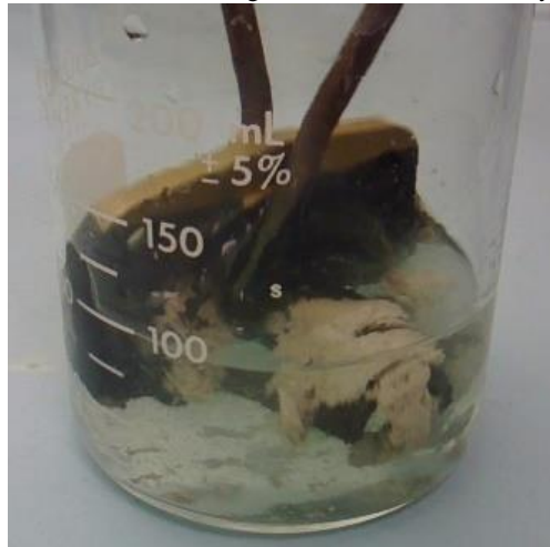
Fig. 3.17 Pieza de latón sumergida en Solución de \text{HNO}_3 y \text{AgNO}_3 .
