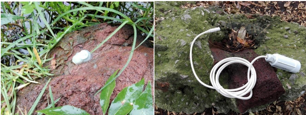
Figura 4. A Uso de Modelos de Agar equipados con I Buttons Y B hobbo Data Loggers para la caracterización hídrica y térmica de los lugares de estudio.
