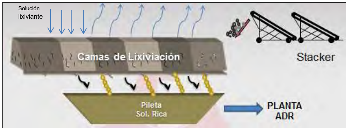
Figura 2.1 Representación esquemática del proceso heap leaching [16].
