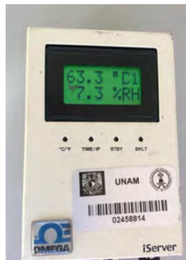
Figura 3.7: Sensor de humedad y temperatura tipo micrófono
