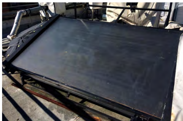
Figura 3.2: Captador solar para calentamiento de aire
