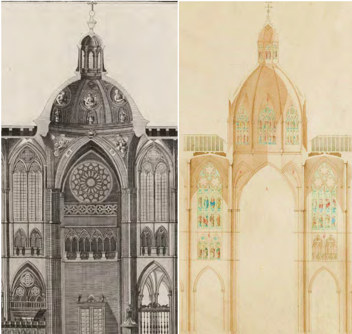
Imagen 3 (Detalle) – Imagen 6 Proyección de la cúpula, en corte transversal, realizado por Matías Laviña, 1859. Comparación con la cúpula de Juan de Naveda, derribada por Laviña. ACL, Archivo de la Restauración de la catedral de León, Planos, R.(P) 021r.
