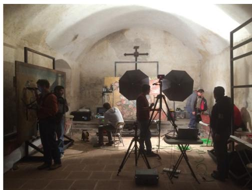
Figura 1. Detalle de estudio de pinturas *in situ* mediante técnicas de imagen y espectroscopías FORS y FRX. Foto: Nathael Cano, 2018.
