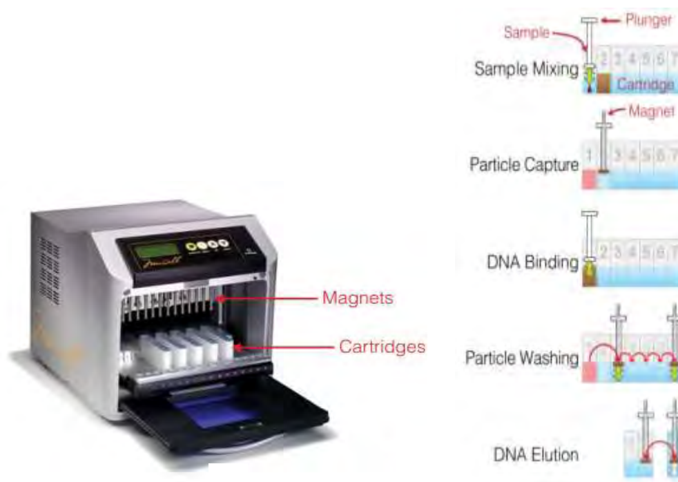
Figura 11. Maxwell® 16 Instrument y el proceso de purificación con DNA IQ™ Casework Pro Kit. Tomado de Maxwell® 16 System. Promega (2012). (43)
