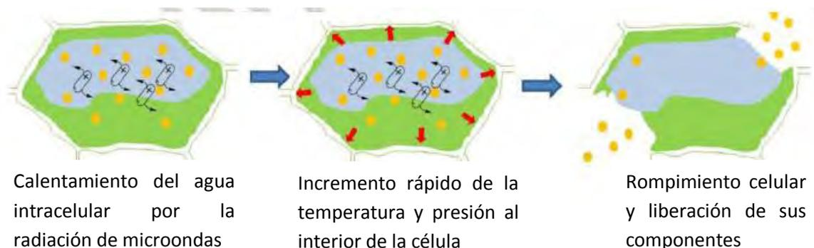
Figura 1.12. Mecanismo de extracción con microondas, sin utilizar solventes (Vinatoru *et al.*, 2017).
