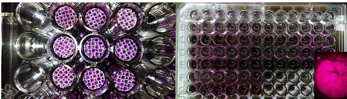
Fig. 22 Respuesta colorimétrica para diferentes cultivos celulares de fibroblastos gingivales humanos en el PLA después del proceso de manufactura aditiva. Izq. Andamios después de realizada la prueba de MTT. Der. Pozos empleados para la lectura en placa ELISA; en el recuadro se observa uno de los cristales de formazán.
