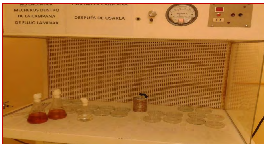
Figura 20. Prueba de límites microbianos en la campana de flujo laminar
