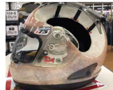
Figura 2.3 Corte de un casco Arai. Fuente propia
